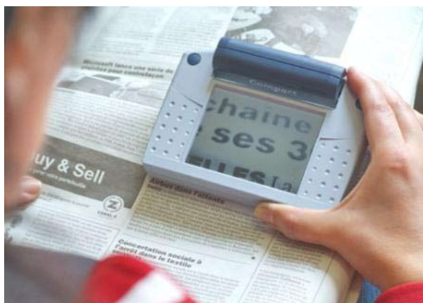
Le système de vidéo-loupe permet un agrandissement important pour faciliter la lecture chez les personnes malvoyantes.
